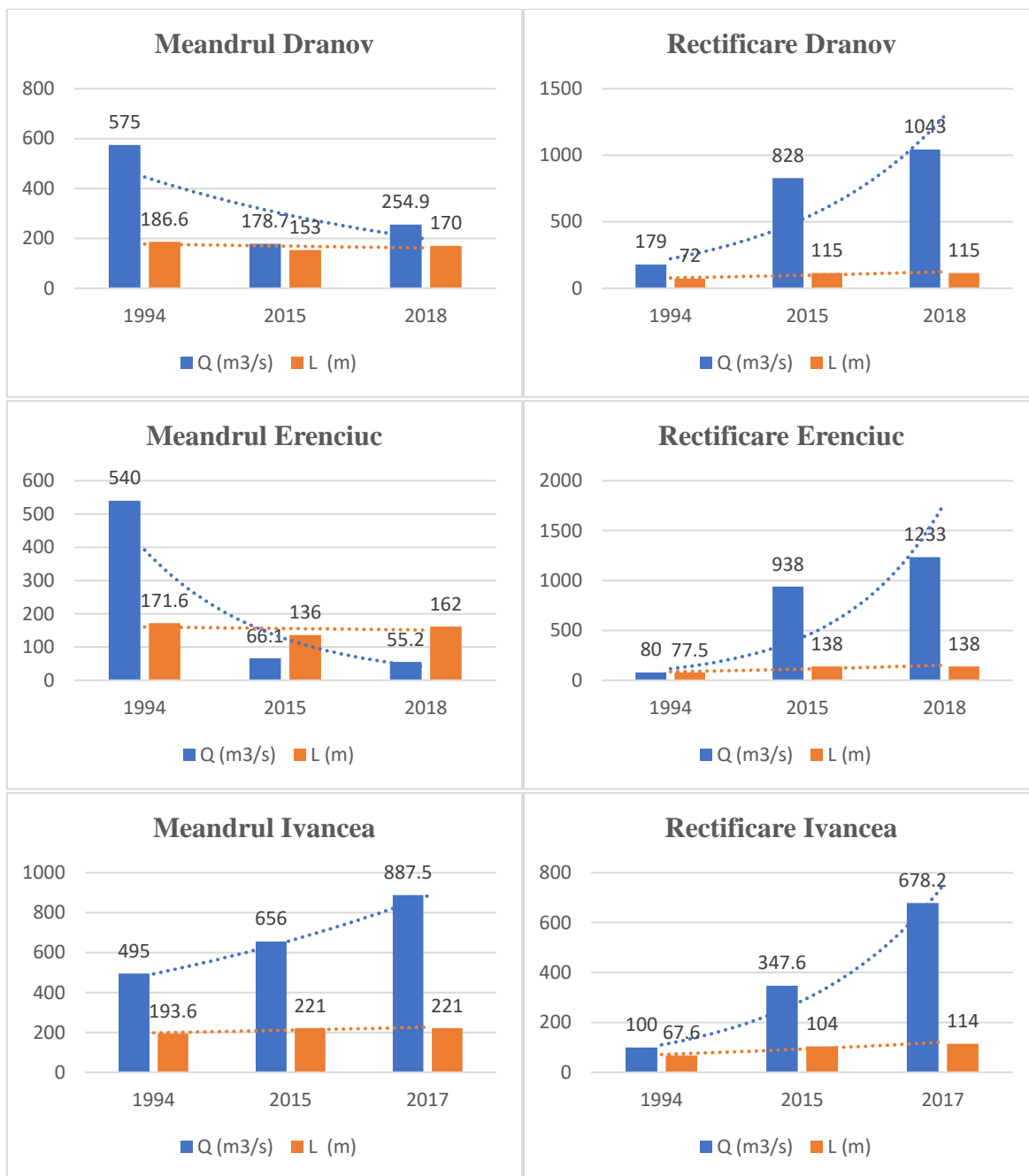
Figura 43 Evoluția debitelor și a lățimii secțiunilor pentru sistemele meandru-canal de rectificare Dranov, Erenciuc și Ivancea între anii 1994, 2015, 2017/2018
