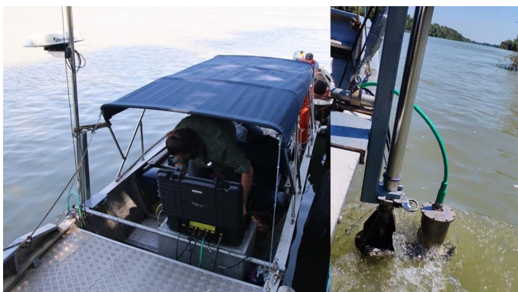
Figura 2 Asamblarea sistemului sonar multifascicul
