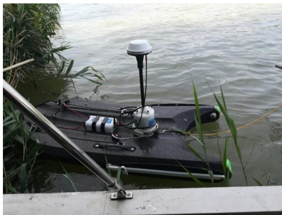
Figura 7 Echipamentul ADCP utilizat în colectarea datelor de debite și viteze ale apei.
