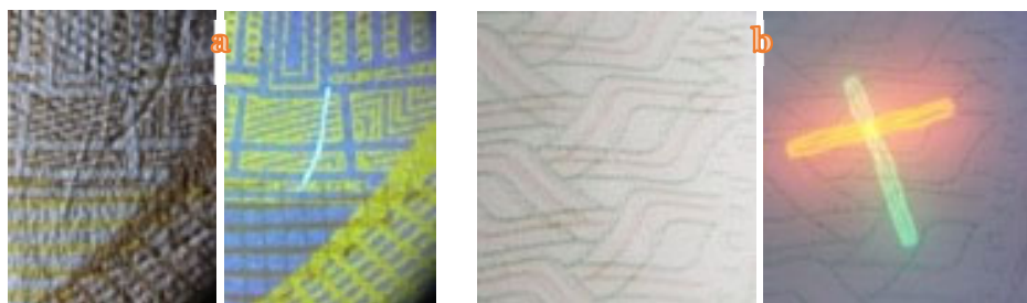
Fig. 5. Fibre în lumină naturală și lumină UV 365 nm: (a) în substrat de hârtie, (b) în policarbonat
