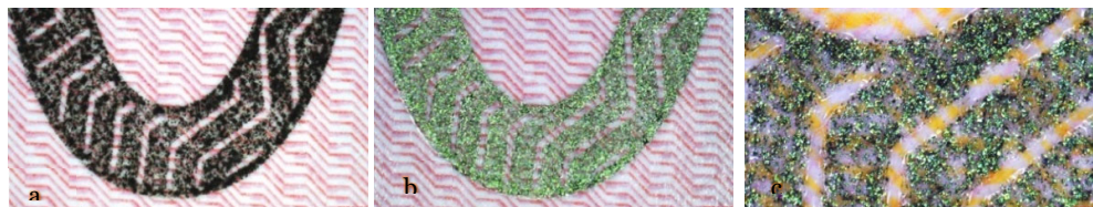
Fig. 17. Detalii ale cernelii optic variabile imprimate intaglio în lumină naturală polarizată (a), lumină naturală fără filtru de polarizare (b) și detaliu tehnicii de imprimare intaglio (c)
