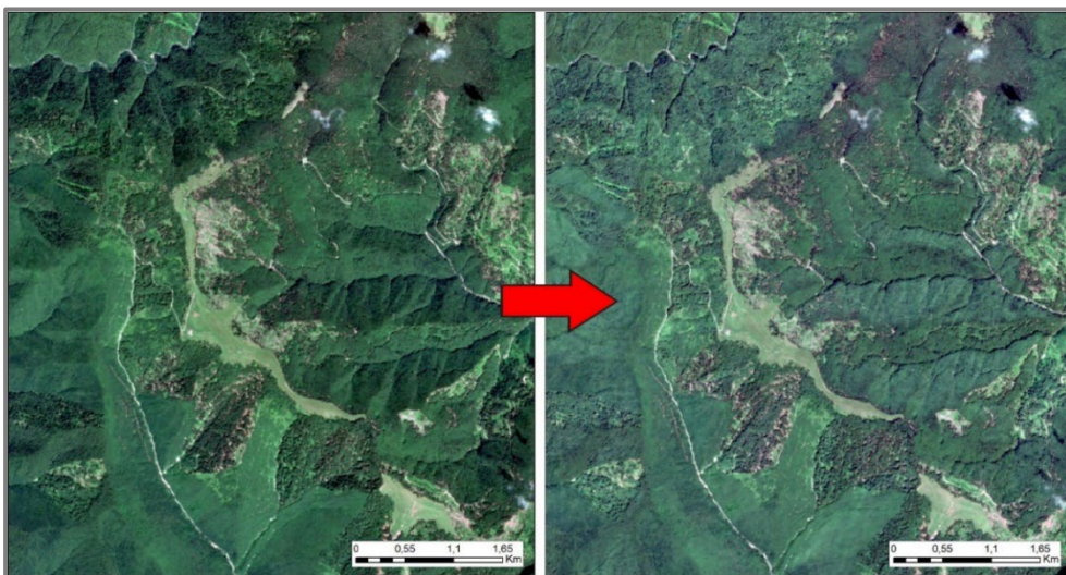
Figura 3. Comparație între imagine necorectată de tip L-1C și imagine prelucrată de tip L-2A (Kathmann, Ciutea, 2017)
